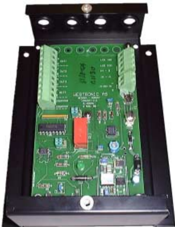
Westronic CBG-3 har solide koblinger for rask og sikker kobling av kabler fra eksternt utstyr.
